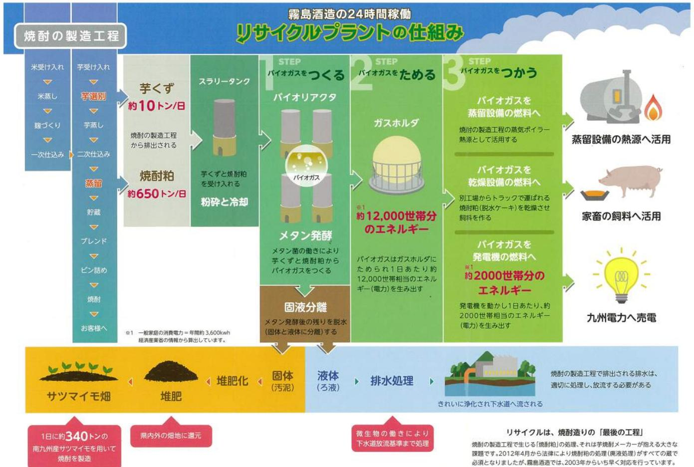
製造工程で出てくる副産物に芋くずと焼酎粕がある。あわせて1日700トンにもなる。これをひとつはバイオガスに換える。このバイオガスは自社の蒸留設備の熱源で活用し、また発電機燃料として約2000世帯相当の電力も生み出している。
